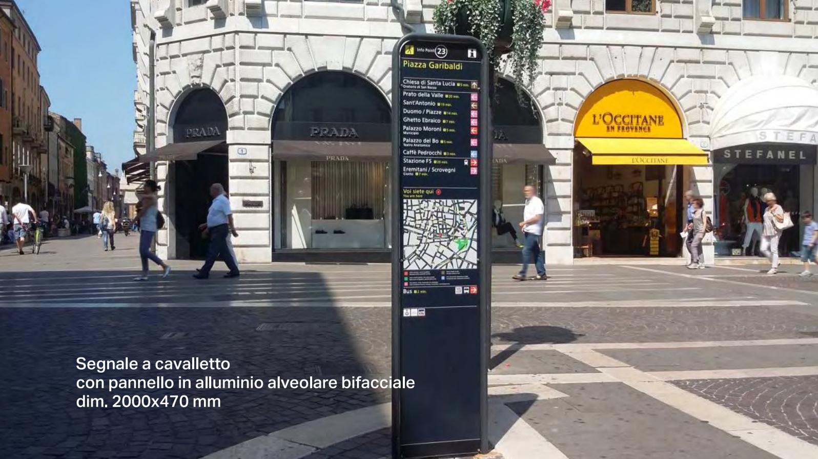
Segnale a cavalletto con pannello in alluminio alveolare bifacciale dim. 2000x470 mm
