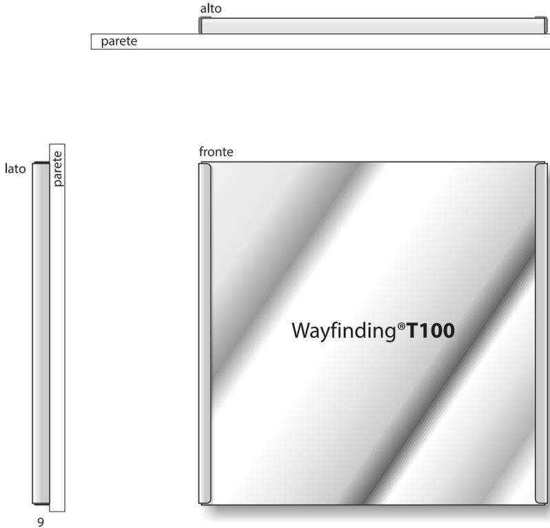
Sistema di segnaletica a pannelli murali intercambiabili a superficie piana in acciaio inox spazzolato AISI 304 sp. 0,6 mm. Sagomato ai lati, è provvisto di profili verticali in acciaio inox lucido AISI 430 sp. 0,8 mm. Fissaggio a muro mediante viti e tasselli a scomparsa. La grafica viene realizzata mediante applicazione di testi in pellicola vinilica adesiva.
